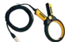
Pinzas inductivas para inducir señales en cables cuando no es posible un acceso directo.
