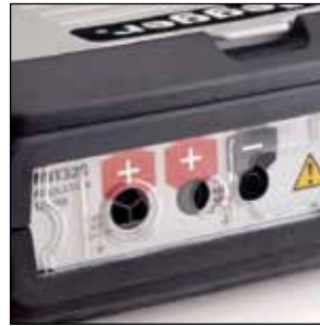
Obturador para evitar combinaciones de conectores peligrosas
